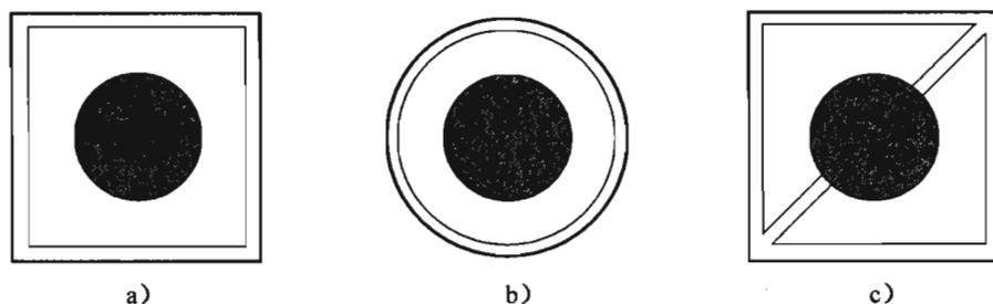
图 7 单检查井盖测试垫块及其几何中心
